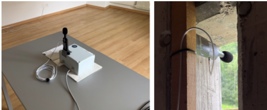
Abbildung 1.29: Einsatz eines SPL-Loggers für eine Baustellenüberwachung im Innenraum (links) und zur Unterstützung einer Langzeitmessung an einer Hausfassade (rechts)
