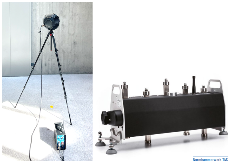
Abbildung 1.30: Dodekaeder mit Verstärker (links), Normhammerwerk mit sichtbaren Hämmern (rechts), Quelle: [2]
