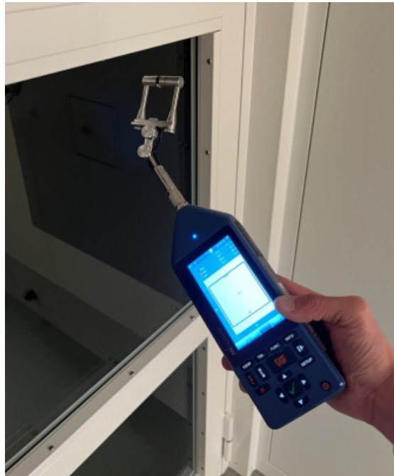
Abbildung 1.27: Messung einer Türe mit der Intensitätssonde von Norsonic
