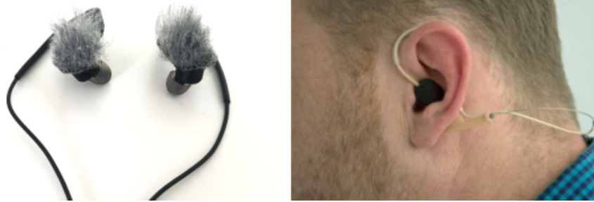
Abbildung 1.25: Mikrofone zur Platzierung an echten Köpfen, Sennheiser Smart Headset Ambeo (links), B&K 4101 (rechts)
